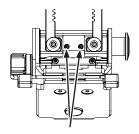
INSERT 1/16 HEX DRIVER TO ADJUST. TURN CCW TO LOOSEN, CW TO TIGHTEN.
